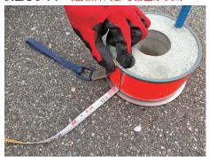
測定中に基点がずれないよう、 付属のクリップで巻尺を固定します。
