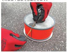
本体中心が巻尺のゼロ目盛になるよう位置を調整します。(底板外周部で目盛が8cm)
